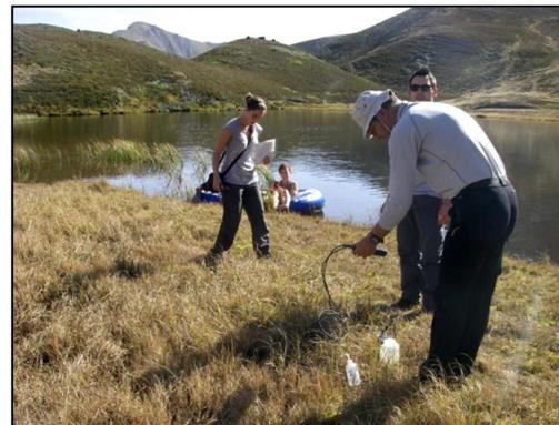
Figure 3: Mesures physico-chimiques sur le terrain avec les sondes multiparamètres (Juillet à gauche et Octobre à droite)
