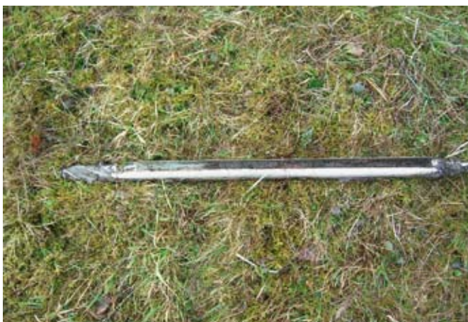
Fig.3 Tarière (modèle Hiller) avec chambre remplie de marne et de tourbe
