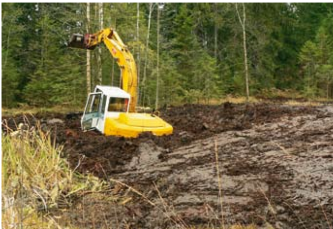
Fig. 31 Rétropelleuse enfoncée dans la tourbe
