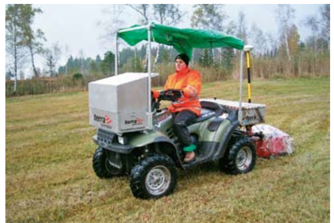
Fig.4 Géoradar monté sur un quad
