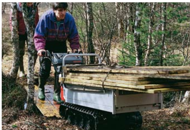
Fig. 66 Brouette à moteur sur chenillettes pour le transport du matériel
