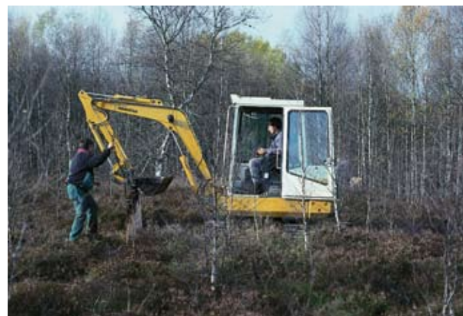
Fig. 67 Rétropelleuse 10 à 12 tonnes à chenillettes
