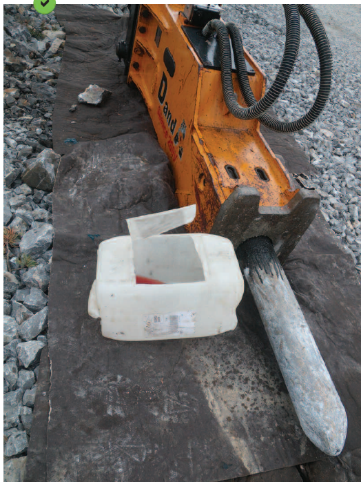
Équipement posé sur géotextile absorbant.
