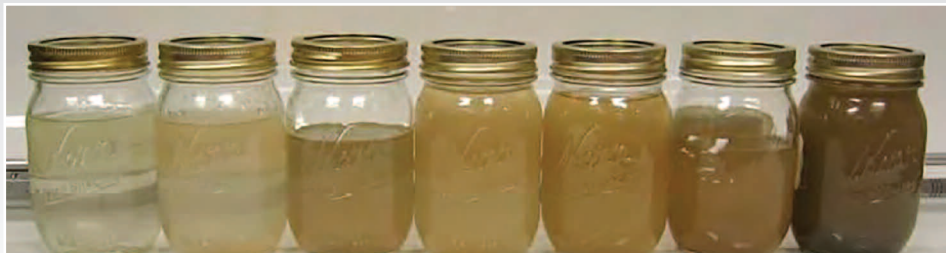
Turbidité (NTU) croissante d'un cours d'eau pendant travaux.
