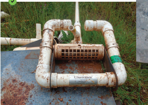
Installation d'un skimmer au sein d'un bassin de décantation provisoire.
