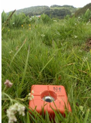
Figure 2 : borne de géomètre installée à l'angle sud-est de la placette
