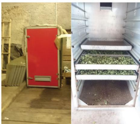
Séchoir actif avec préchauffage de l'air pulsé
