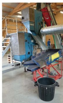
Sasseur et mondeuse à deux niveaux de soufflerie montés en série avec un tri final par calibre et poids
