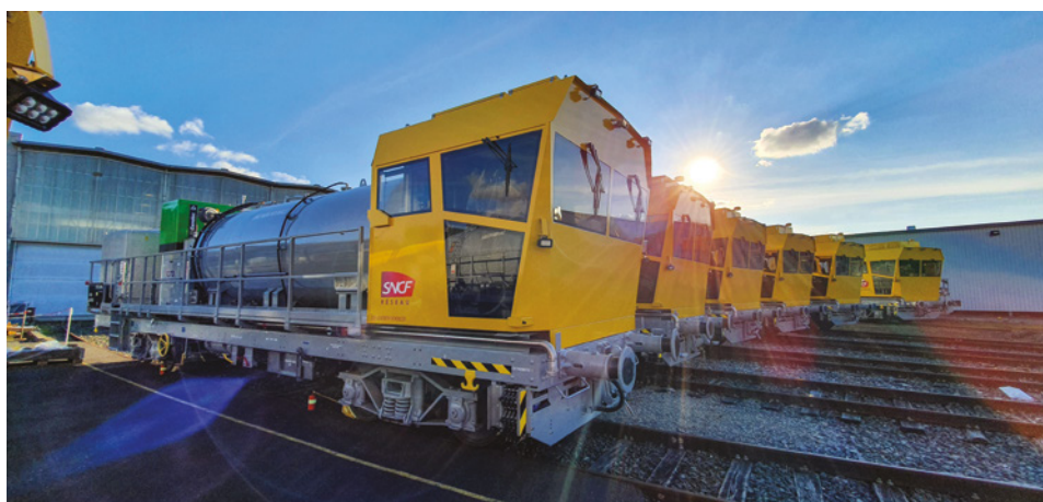
Figure 3-30 : Train désherbeur (SNCF Réseau)
