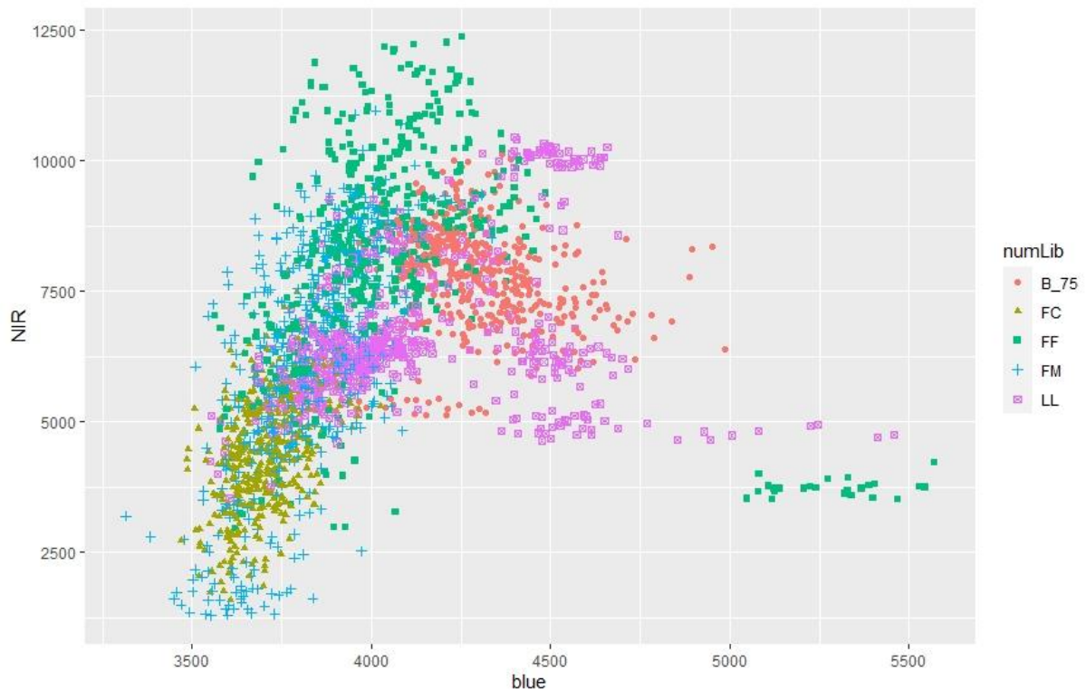
Figure 57 : Ex. d'un diagramme bidimensionnel des nuages de points des classes des zones d'entraînements (buis – B_75, conifères-FC, feuillus-FF, forêts mixte-FM, prairies et landes – LL) en fonctions des bandes spectrales, bleu et proche infra-rouge, d'une image satellite RapiEye
