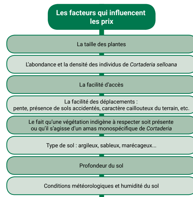
Figure 6.2. Facteurs qui influencent le coût des travaux de contrôle et d'éradication de Cortaderia selloana .
