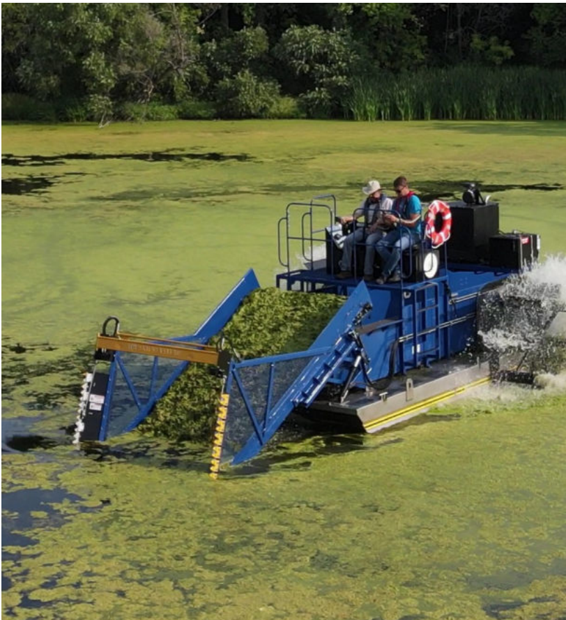
Fig 11. L'arrachage mécanique par le biais d'engins flottants est généralement mis en place dans des plans d'eau de grande dimension. Photo : Aquarius Systems
