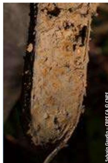
FIGURE 17 : TACHES DE ROUILLES SUR LA MATRICE MONTRANT UNE HYDROMORPHIE
