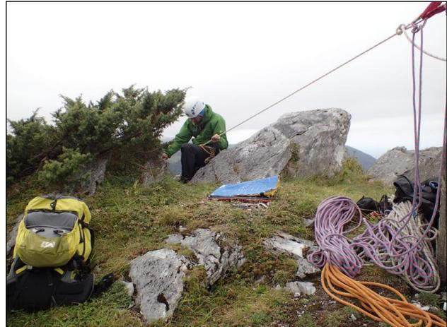
Les ancrages des points dans la roche ne pouvant se faire que sur des roches saines (non fragmentées, non friables), et afin d'éviter des phénomènes de frottement de la corde, des amarrages naturels (arbres) et existants (pylônes) ont été utilisés pour attacher des cordes et atteindre le haut de la falaise. Des trous ont alors été percés à l'aplomb des falaises pour y ancrer des points solides (goujons).
