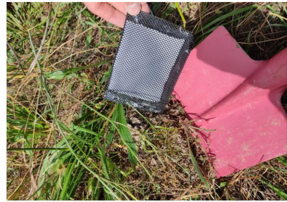
B : enfoncez la bêche dans le sol, soulevez le bloc de sol, et glissez le litter bag horizontalement
