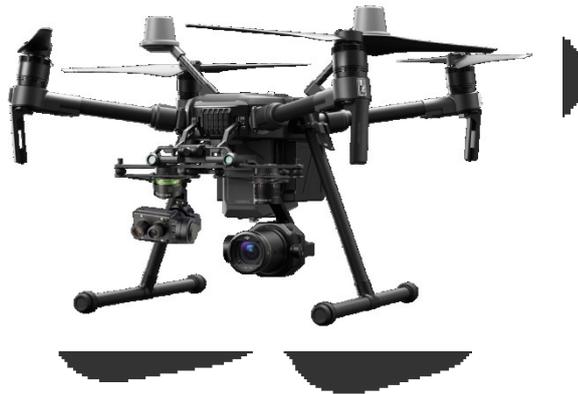
Figure 2 : drone à rotors de type DJI M210 RTK v2
