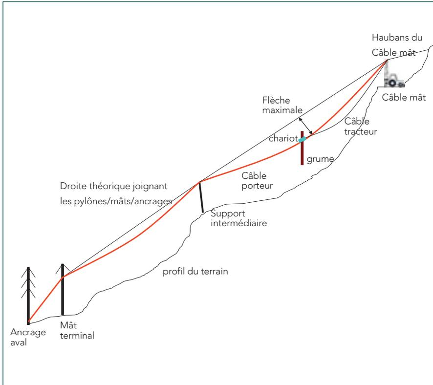
Fig. 2 : schéma d'un profil de câble
