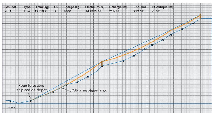
Fig. 4 : ligne réalisée à l'intuition ; sur les 150 m du bas de la ligne, le câble porteur est trop bas et ne permet pas de lever la charge suffisamment
