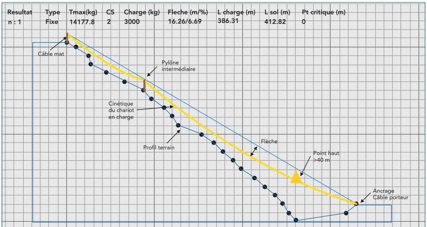
Fig. 3 : restitution SIMULCABLE avec les indications des principaux éléments, le carroyage (10 m x 10 m) donne l'échelle du profil
