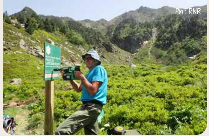
Il s'agit de cellule pyroélectrique qui détecte le passage des randonneurs. Leur objectif est d'évaluer quantitativement la fréquentation de la réserve, ainsi que son évolution et permet d'évaluer l'efficacité des outils de gestion (canalisation, effet de concentration, pic de fréquentation, efficacité du balisage...).
