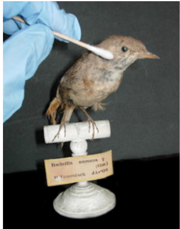
Prélèvement de résidus sur le spécimen au moyen d'un coton-tige © Amandine Péquignot
