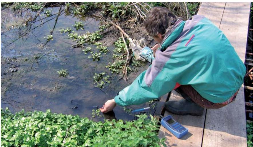
Mesure de qualité de l'eau à l'aide d'une sonde multiparamètres / N.Cottin
