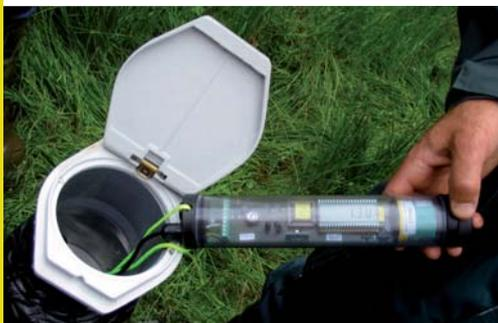
Codeur limnimétrique Thalimèdes et piézomètre
