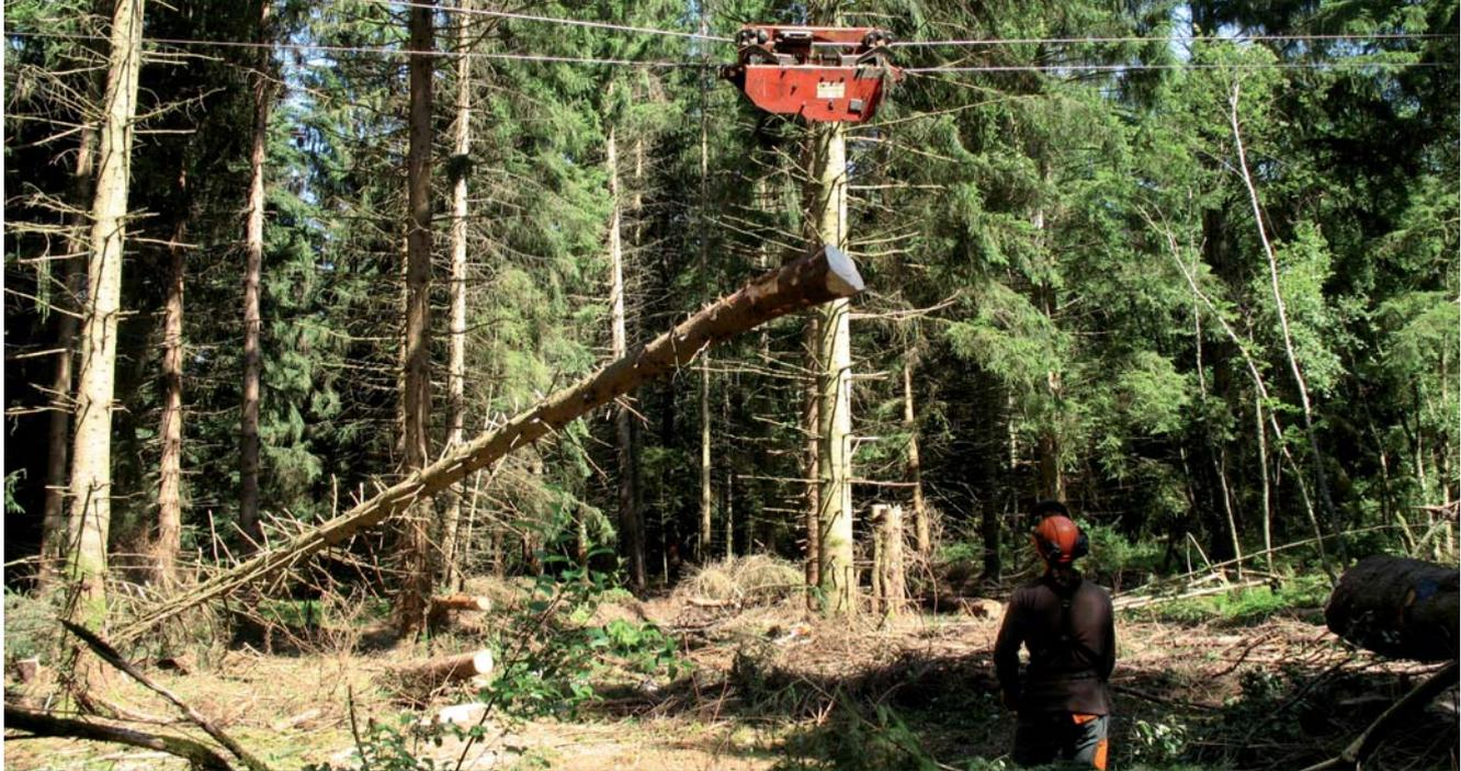
Exploitation de résineux par câble-mât dans le Morvan / PNR du Morvan
