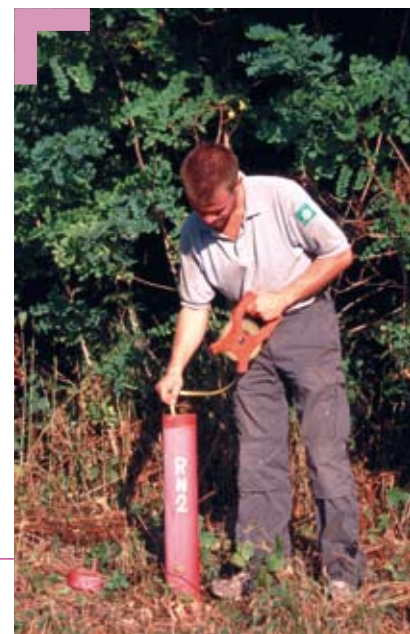
Relevé du niveau d'eau dans un piézomètre.
