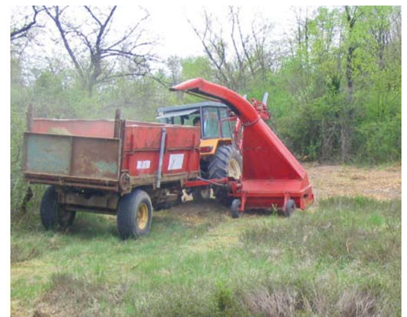
Le ramassage du broyat à l'aide d'une ensileuse a été testé mais abandonné en raison d'un surcoût important.
