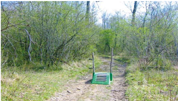
Une clôture électrique et un dispositif de franchissement pour piétons et deux-roues (basse vallée de l'Ain).
