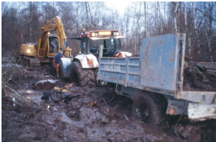
Sur la lande tourbeuse des Oignons (Ain), les allers et retours d'un tracteur avec un tombereau, combinés au dégel en fin de matinée, ont conduit, suite à une déstructuration du sol causée par l'embourbement de l'équipage, à l'interruption et au report complet du chantier sur l'année suivante.
