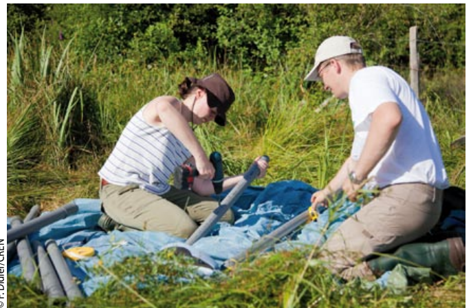
Fabrication "sur-mesure" de piézomètres.
