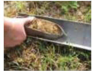
D. Déposer ces 20 premiers centimètres dans la gouttière aux graduations correspondantes.
