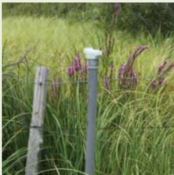
Piézomètre équipé d'une sonde de mesure automatique
