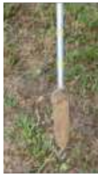
B. Lorsque la tête de la tarière est remplie, cela correspond à un avancement de 20 cm.
