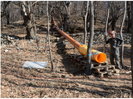
Fig. 7. Tests de chutes de pierres sur des ailantes adultes avec une boule de granit pesant 50 kg, près de San Vittore (GR). À droite: capacité d'absorption d'énergie de l'ailante en comparaison avec le hêtre (Moos et al. 2019). Les valeurs au-dessus de la ligne rouge 1:1 indiquent une capacité d'absorption d'énergie supérieure du hêtre.
