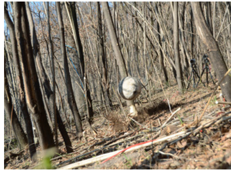
Fig. 7. Tests de chutes de pierres sur des ailantes adultes avec une boule de granit pesant 50 kg, près de San Vittore (GR). À droite: capacité d'absorption d'énergie de l'ailante en comparaison avec le hêtre (Moos et al. 2019). Les valeurs au-dessus de la ligne rouge 1:1 indiquent une capacité d'absorption d'énergie supérieure du hêtre.
