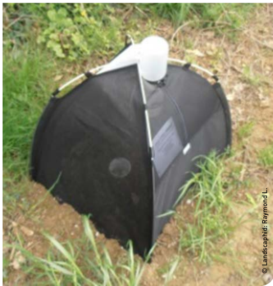
Tente à émergence pour capturer les insectes hivernant dans le sol et la végétation ainsi recouverts
