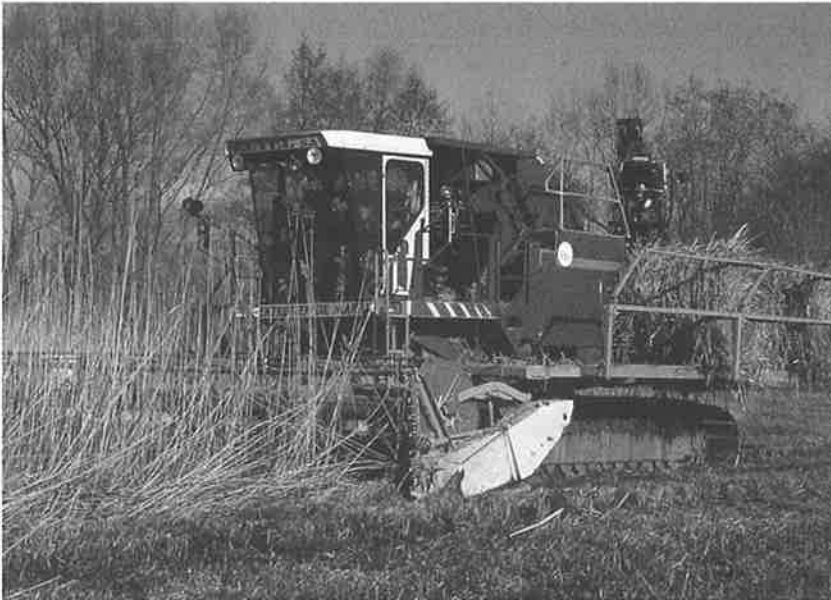
Fig. 1: La machine Elbotel a été conçue pour faucher de grandes surfaces de marais. Ses caractéristiques (largeur du peigne de coupe: 6.2 m, volume de paille embarqué: 6 t, vitesse de déplacement: 5 km/h) lui permettent de faucher, botteler la paille et la transporter en dehors du marais au rythme de 1 ha traité en moyenne par jour. Ce volume de travail lui permet de respecter l'exigence de l'arrêt du fauchage à début février, avant que ne démarre la migration des batraciens. En contrepartie de ses performances, la machine pèse 26 t avec son chargement de paille complet, mais réparti ce poids sur 2 chenilles couvrant ensemble 12 m 2 . La pression au sol ainsi obtenue correspond à celle d'un être humain.
