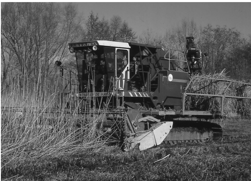
Fig. 1: La machine Elbotel a été conçue pour faucher de grandes surfaces de marais. Ses caractéristiques (largeur du peigne de coupe: 6.2 m, volume de paille embarqué: 6 t, vitesse de déplacement: 5 km/h) lui permettent de faucher, botteler la paille et la transporter en dehors du marais au rythme de 1 ha traité en moyenne par jour. Ce volume de travail lui permet de respecter l'exigence de l'arrêt du fauchage à début février, avant que ne démarre la migration des batraciens. En contrepartie de ses performances, la machine pèse 26 t avec son chargement de paille complet, mais répartit ce poids sur 2 chenilles couvrant ensemble 12 m 2 . La pression au sol ainsi obtenue correspond à celle d'un être humain.
