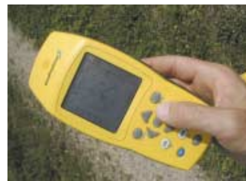
Photo n°43 : GPS utilisé dans les RN de Franche Comté. Ce modèle, avec une capacité de 1Mo, permet de stocker les données de une à deux journées de terrain. D'une précision de 1-5 mètres, il est compatible avec Map Info. Son coût est de 6 000 €. Un autre GPS est utilisé pour des relevés ponctuels (coût : 200 €). © Photo : F. TAUPIN.
