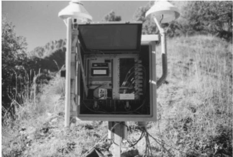
▲ Photo 4. – Station d'enregistrement des températures (photo V. Magnin).
