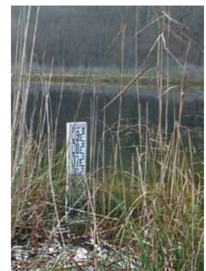
Une règle limnimétrique.
