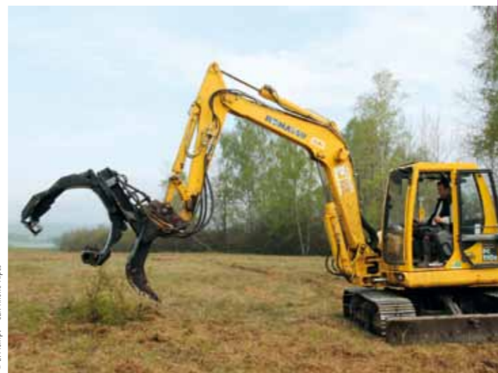
Cette pince permet d'arracher plusieurs rejets d'arbustes à la fois.
