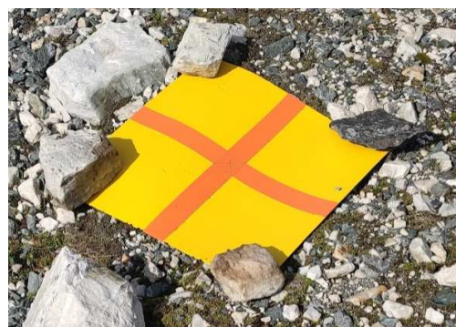
Figure 13 - Cible GCP installée sur la marge proglaciaire de Gébroulaz (fabrication : Anaïs Zimmer).
