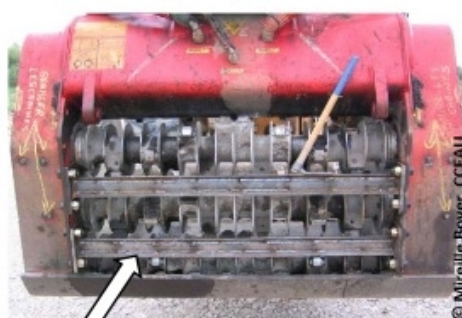
Barres de broyage sur un godet concasseur
