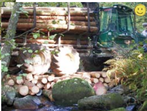
Problème d'érosion induisant un ensablement du cours d'eau (en haut) et tracteur forestier empruntant un franchissement temporaire aménagé (à droite).
