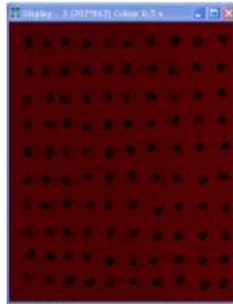
Figure 52 - Image contrastée. Sert à délimiter avec clarté le contour des objets à mesurer. (photo: G. Venora)
