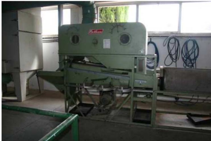
Figure 18 - Machine à flux d'air avec cylindre denté pour le tri des semences. (photo: A. Prada)
