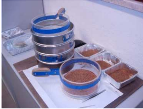
Figure 16 – Batterie de tamis utilisés par la Banca del Germoplasma della Sardegna (BG-SAR). (photo: E. Mattana)
