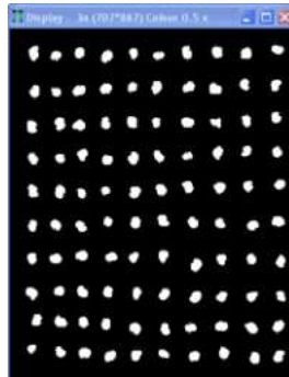
Figure 53 - Image segmentée. Permet la séparation par rapport au fond, des objets à mesurer, et représente l'image caractéristique qui va permettre au système de distinguer quels sont les objets à mesurer. (photo: G. Venora)
