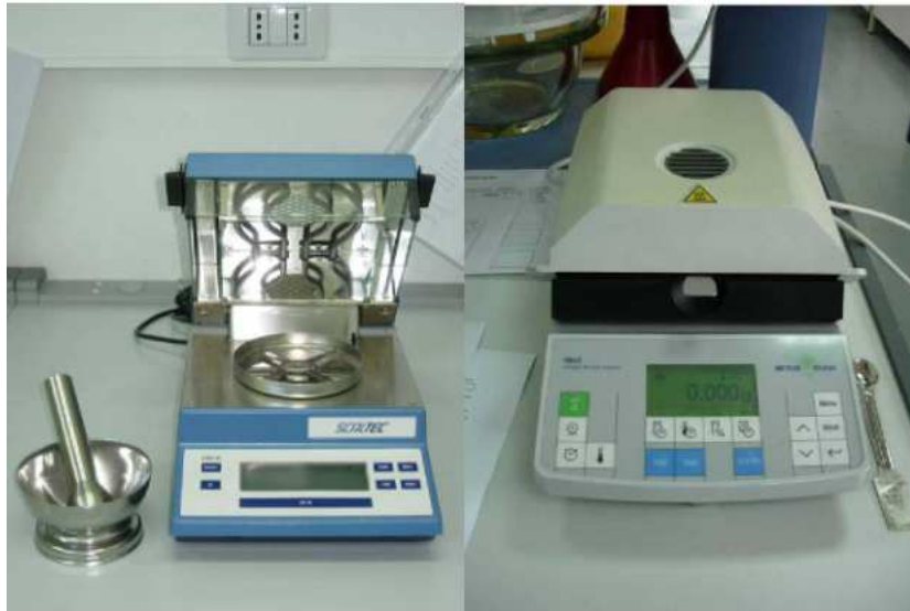
Figura 20 – Exemple d'analyseurs électroniques de l'humidité ou thermo-balances, en usage à la Banca del Germoplasma della Sardegna (BG-SAR) et la Banc de Llavors Forestals (CIEF). (photo: E. Mattana)
