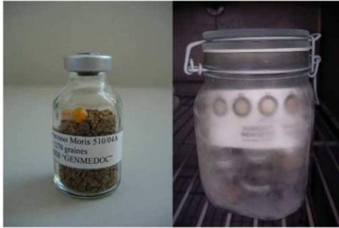
Figure 26 – Flacons en verre avec fermeture sous pression en usage au BG-SAR avec à l'intérieur, pour suivre la teneur en humidité, deux gélules transparentes en gélatine avec gel de silice en micro-granule et un bocal en verre fermé sous pression avec une étiquette en papier pour le suivi de l'humidité. (photo: E. Mattana)
