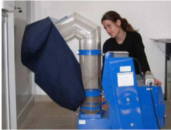
Figure 17 – Machine pour le tri gravimétrique des semences en usage à la BG-SAR. (photo: E. Mattana)
