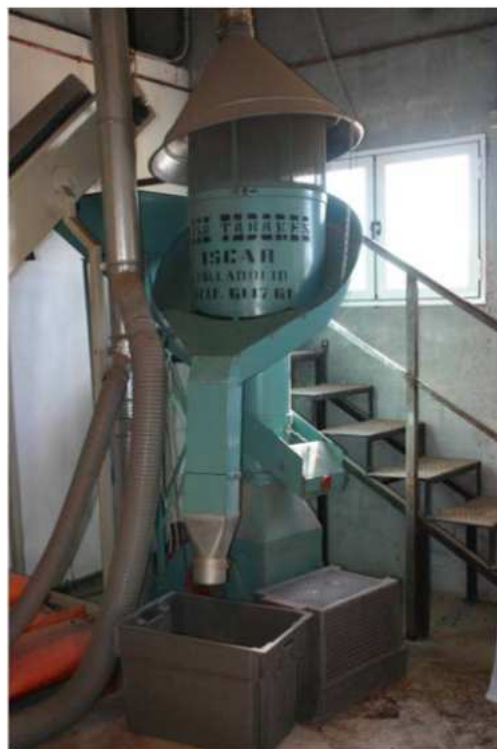
Figure 19 – Machine à flux d'air pour le tri des gros lots de semences. (photo: A. Prada)
