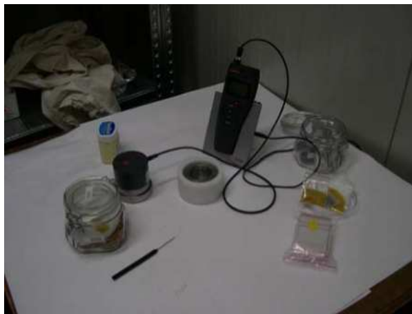
Figure 23 – Instrument pour la mesure de l'activité de l'eau ( a_w ) en usage au M.A.I.Ch. (Crête). (photo: G. Bacchetta)
