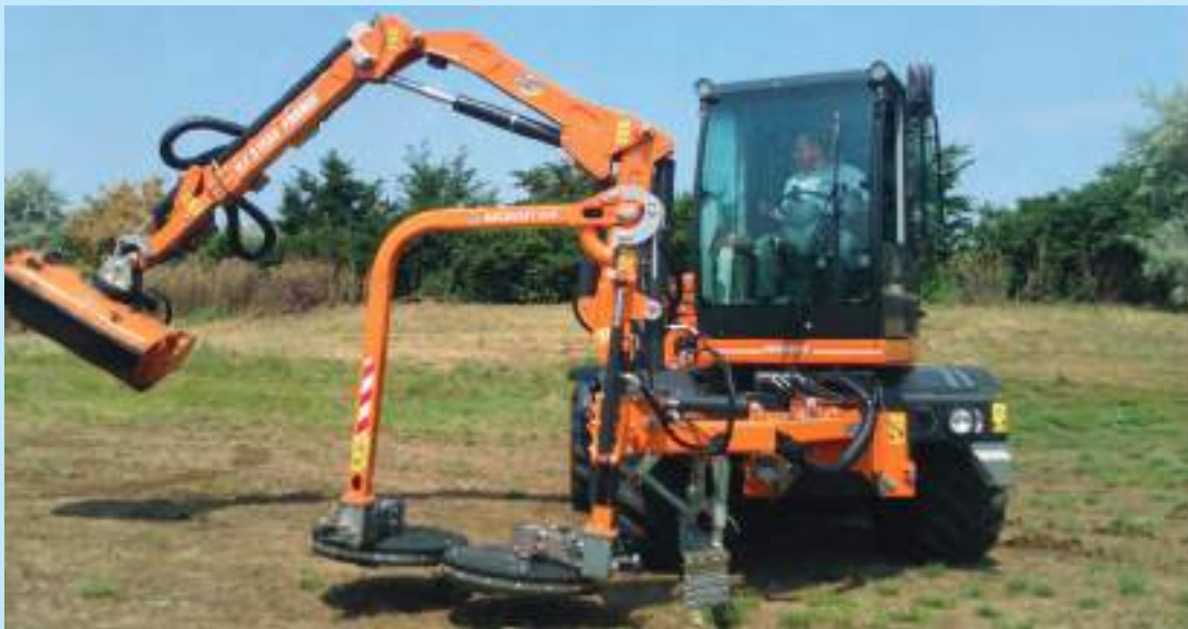
Tracteur équipé d'un broyeur et d'une faucheuse sous glissière. © Cerema
