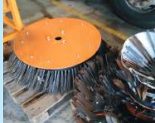
Brosses de désherbage et de balayage. © Cerema
