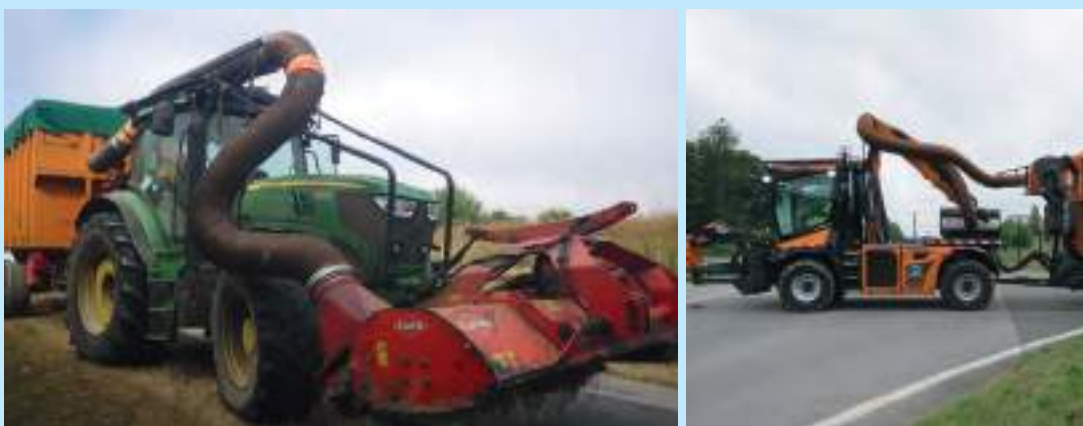
Dispositif de fauchage avec aspiration vers un caisson. © Cerema
