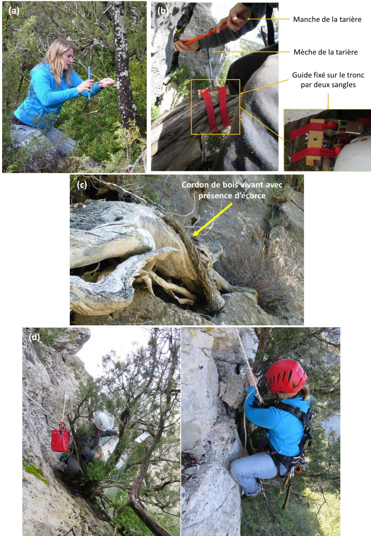
**Figure 6.3** : Prélèvement d'une carotte à l'aide d'une tarière de Pressler : (a) position de carottage avec une main placée tout près du filetage frontal, (b) guide de carottage, (c) cordon de bois vivant sur un arbre de falaise et (d) position de carottage en falaise. © Christophe Buquet et Coralie Mathaux
