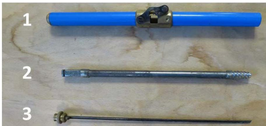
Figure 6.1 : Composition de la tarière de Pressler : (1) le manche, (2) la mèche et (3) la cuillère.
