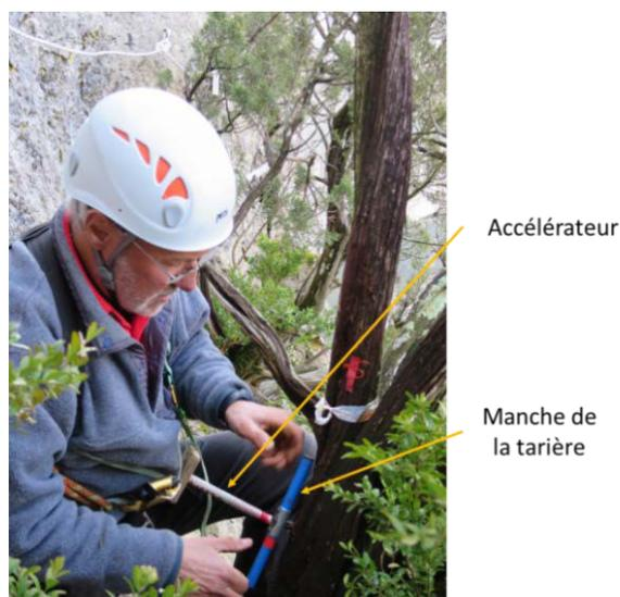
**Figure 6.4** : Prélèvement d'une carotte sur un arbre de falaise à l'aide d'une tarière de Pressler et d'un accélérateur sur la falaise de Gaud Ouest dans les gorges de l'Ardèche.
