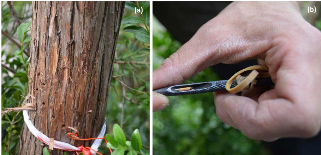
**Figure 14.1 :** (a) Les micro-prélèvements sont effectués selon une spirale ascendante et sont séparés entre eux par une distance de 1.0 cm sur le côté et 1.0 cm vers le haut. (b) Micro-carotte de 2 mm de diamètre et d'environ 10 mm de longueur réalisée à l'aide d'un poinçon à bois.
