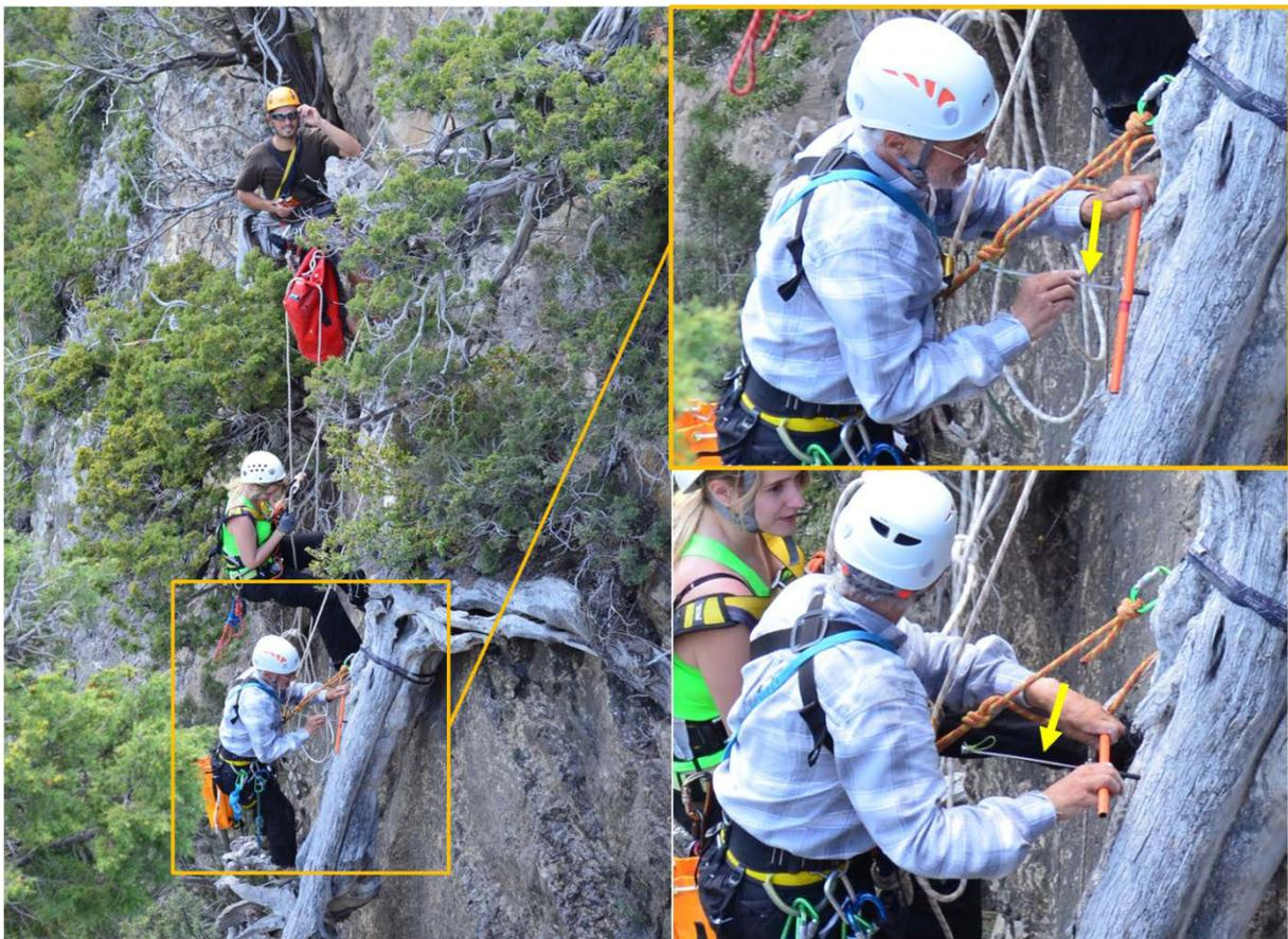
**Figure 6.2** : Prélèvement d'une carotte sur un arbre de falaise des clues de Chambrière (Entrages, Alpes de Haute-Provence) à l'aide d'une tarière de Pressler et mise en place de la cuillère. © Frédéric Guibal
