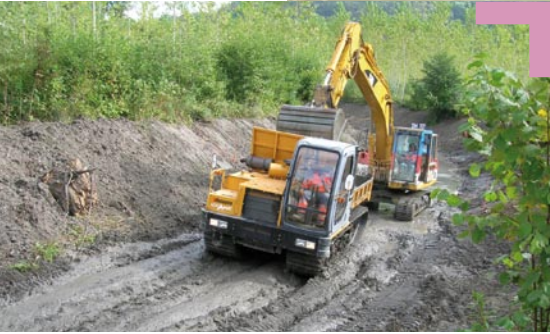
Le transporteur à chenillettes, efficace même sur sols peu portants et détrempés.
