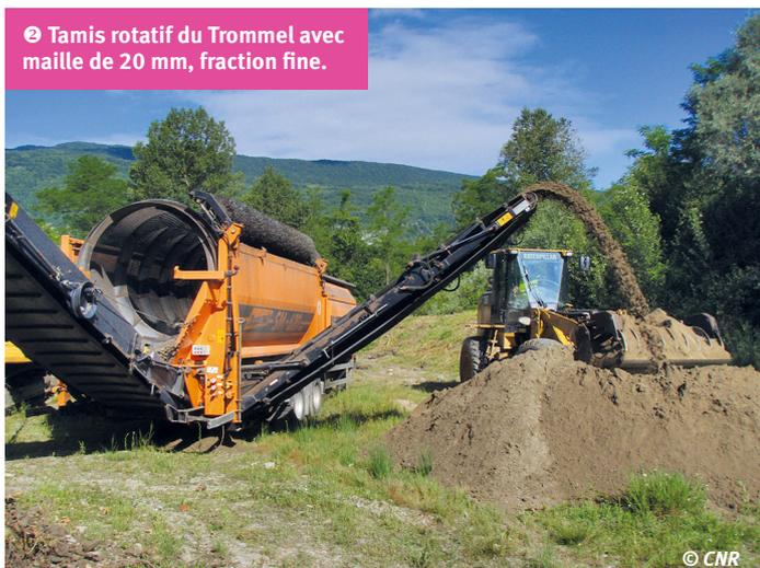
② Tamis rotatif du Trommel avec maille de 20 mm, fraction fine.
