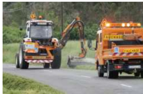
Figure 2 : Fauchage en 3 temps (a) et épareuse sécurisée en action sur accotement (b).
