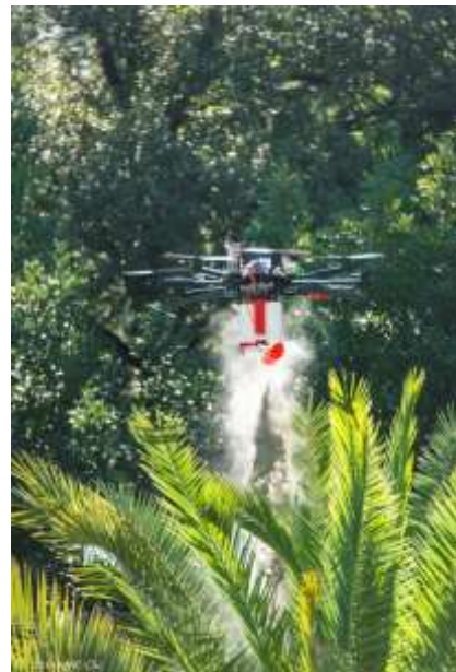
Figure 2 : Drone développé pour l'application de la formulation microgranulée de Beauveria bassiana et largage du produit au-dessus du cœur d'un palmier.
