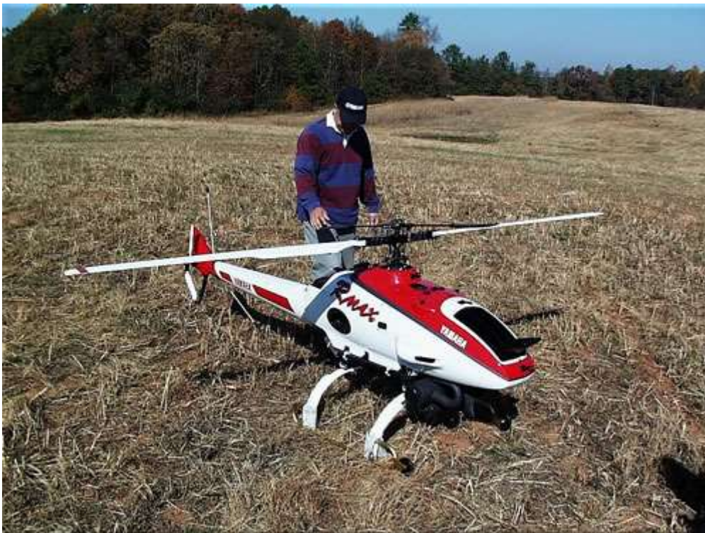
Figure 1 : Drone Yamaha RMAX utilisé pour le traitement des rizières au Japon, capable d'embarquer 16 litres de bouillie dans ses réservoirs. L'appareil doit voler à 24 km/h pour assurer une bonne répartition du produit de traitement. (Drone Yamaha RMAX used for the treatment of rice fields in Japan, able to load 16 liters of treatment mixture in its tanks. The device has to fly at 24 km/h to assume a good product distribution).
