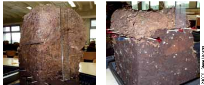
Figure 5. Horizon de surface d'une tourbière drainée en comparaison avec celui d'une tourbière non drainée. Les échantillons sont issus du même secteur d'une tourbière du Bas-Saint-Laurent (Québec).
