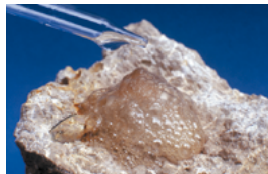
Le calcaire fait effervescence à l'acide
