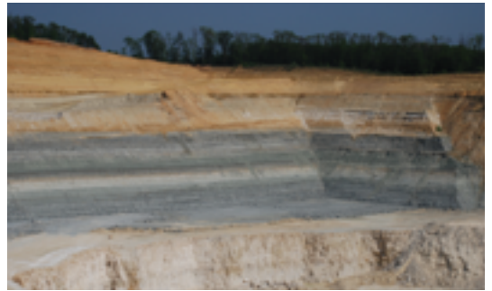
Couches géologiques constituant le sous-sol de la carrière de Cormeilles-en-Parisis (Val-d'Oise) ; de bas en haut : une couche de gypse, puis des marnes supra gypseuses, et au sommet, les sables de Fontainebleau
