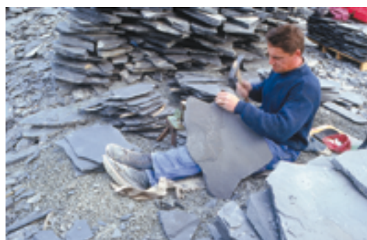
Utilisation du plan de clivage pour fendre l'ardoise en plaques fines et réaliser ainsi un matériau de couverture.
