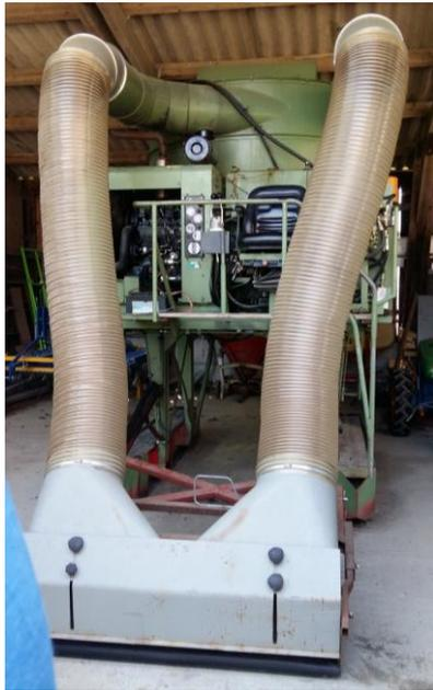
Figure 10 : Photographie d'une machine construite par un producteur pour récolter les graines de plantes anémogames (en culture) | Source : ibid.
