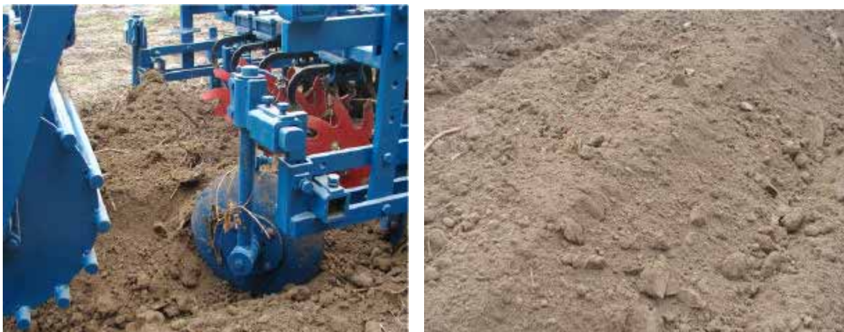
Les disques forment la butte, le rouleau finit le travail (Source GRAB)
