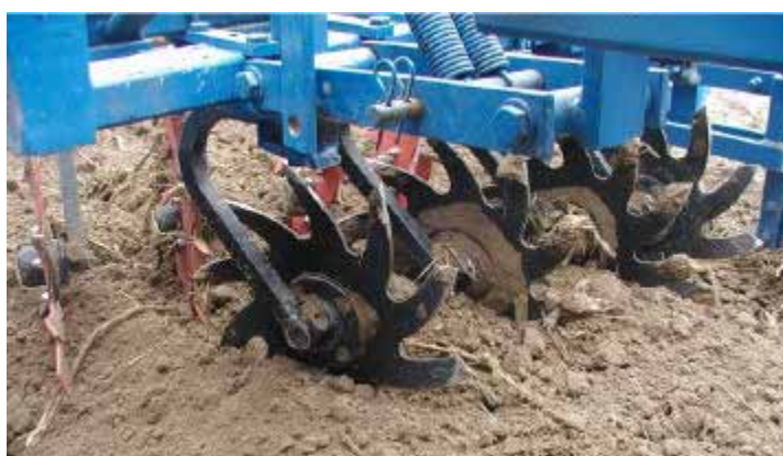
Les disques étoiles travaillent la butte sur 15 cm de profondeur (Source GRAB)
